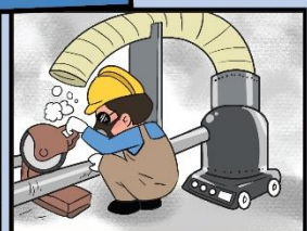
ใช้อุปกรณ์ปิดครอบ/ควบคุม แผลงทำเน็ด ป้องกันฝุ่นฟุ้งกระจาย
