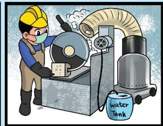
ใช้อุปกรณ์ปิดครอบ/ ควบคุมแหล่งกำเนิด ป้องกันฝุ่นฟุ้งกระจาย
