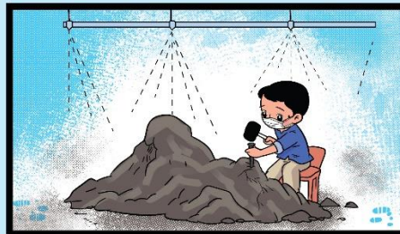
ลดการฟุ้งกระจายฝุ่น เช่น การใช้สเปรย์น้ำ หรือ พรหมน้ำลงวัตถุที่ตัดแต่ง ให้ชุ่มก่อนขณะตัด
